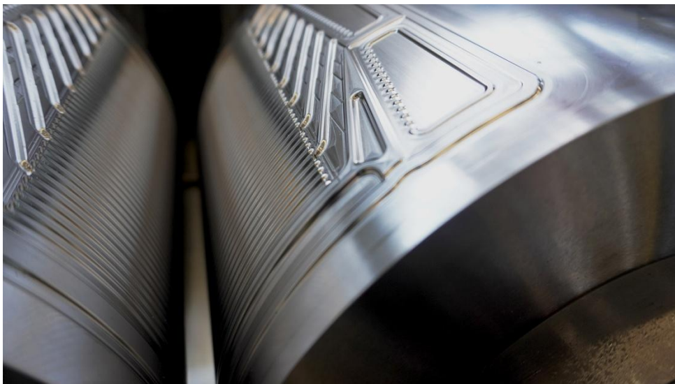
Abb. 1 Anders als beim klassischen Prägen erfolgt die Umformung beim Hohlprägewalzen kontinuierlich zwischen rotierenden Werkzeugen. Das senkt die erforderlichen Prozesskräfte erheblich und schafft die Voraussetzung für Produktionsraten von über 100 Bauteilen pro Minute. © Fraunhofer IWU
