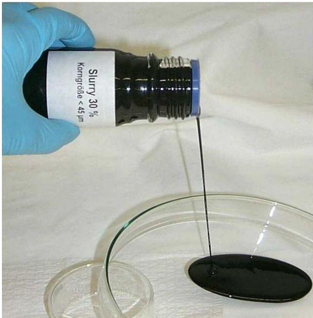
*BioSynCrude<sup>®</sup>: Die Energiedichte dieses Zwischenprodukts ist bis zu zehn Mal höher als die der Ausgangsstoffe. (Foto: IKFT, KIT)*
