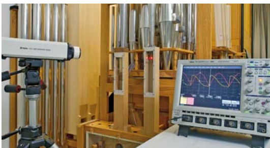
Bild 2: Messung der Zungengeschwindigkeit einer Zungenpfeife mit Hilfe eines Vibrometers. © Fraunhofer IBP
