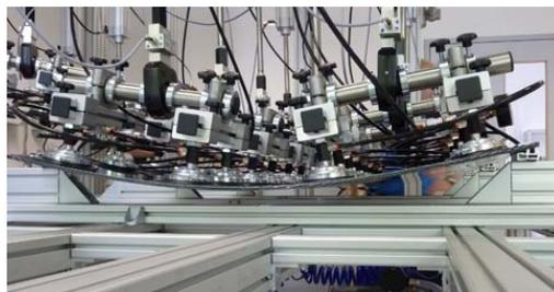
TPedge-Modul, gemeinsame Entwicklung der Bystronic glass und Fraunhofer ISE, bei der mechanischen Lastprüfung
