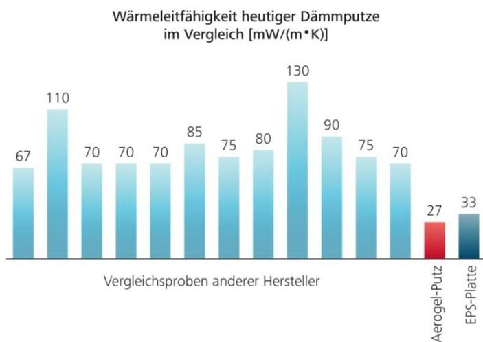
Vergleich von aktuellen Dämmputzen mit dem neu entwickelten Aerogel-Putz: Das Material isoliert vergleichbar gut wie eine EPS-Platte (EPS = Extrudiertes Polystyrol). Grafik: Empa.
