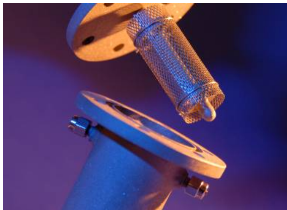
Das Herzstück des neuartigen Brennstoffverdampfers – der Katalysator auf einem Metallnetz. ©Fraunhofer ISE
