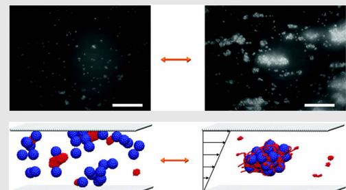
Darstellung der Polymer-Kolloid-Interaktion „in vitro“, mittels Kombination von Interferenzkontrast-Mikroskopie und Fluoreszenzmikroskopie (oben), und „in silico“, in der entsprechenden Computersimulation (unten).
