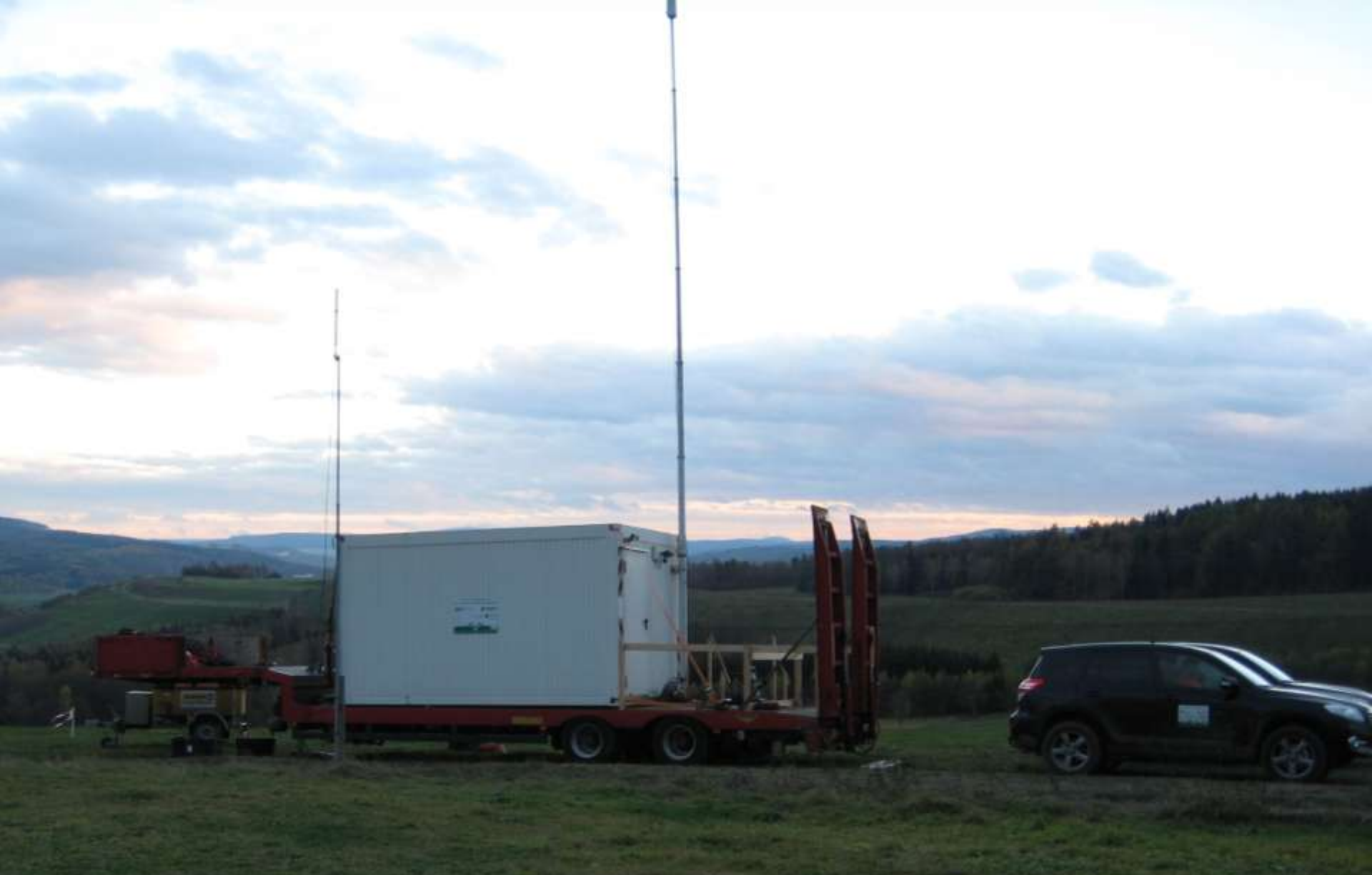
Zentraler Messwagen „Recorder“ zur Ansteuerung und Kontrolle der Vibratoren und des gesamten Messnetzes sowie zur Datenaufzeichnung (hier bei Wildbach)
