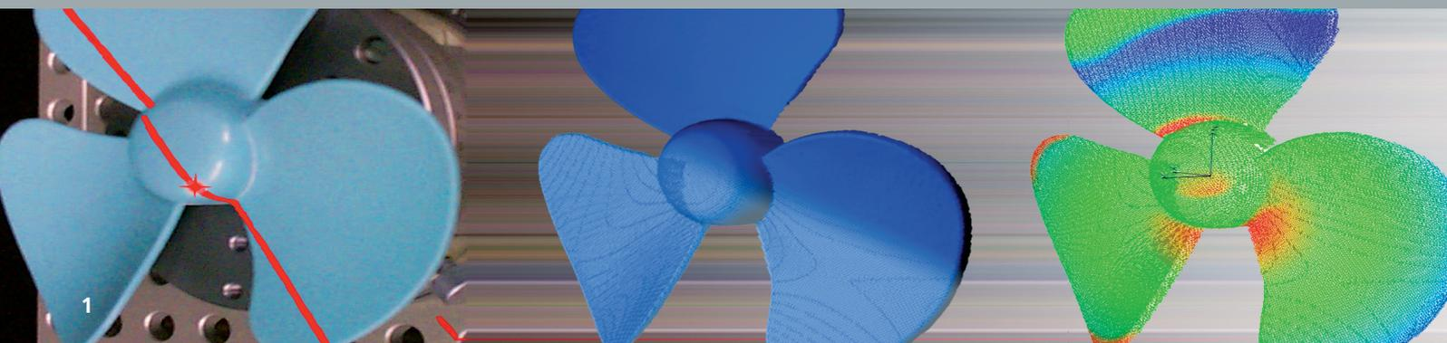
1 Qualitätsprüfung durch optische Messtechniken. Foto: Fraunhofer IFF
