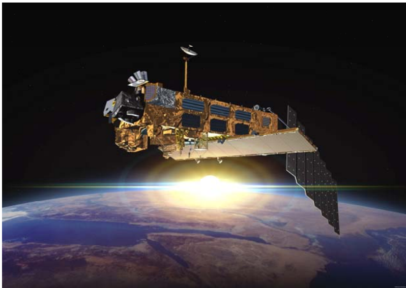
Mit dem Messinstrument MIPAS auf dem europäischen Umweltsatelliten ENVISAT werden mehr als 30 Spurengase gleichzeitig gemessen. (Bild: ESA)
