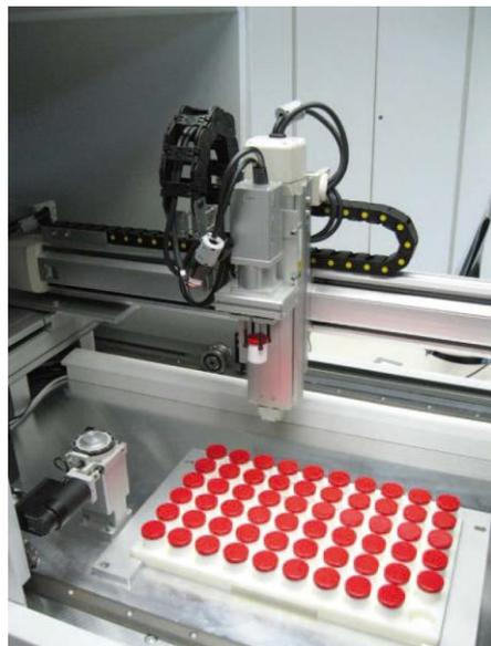
*Ein kartesischer Roboter wechselt die Proben.
