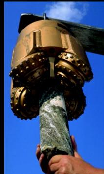
Bohrkern im Bohrkopf
