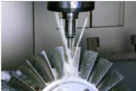
**Bild: Bearbeitungsstrategien, Prozessparameter und Werkzeuge müssen bei der Bearbeitung schwer zerspanbarer Werkstoffe aufeinander abgestimmt werden, Quelle: © Fraunhofer IPT.**
