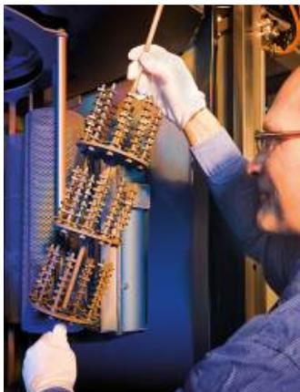
**Bild:** PVD-Beschichtungen für Hochleistungs-Schneidwerkzeuge, Quelle: © Fraunhofer FEP.
