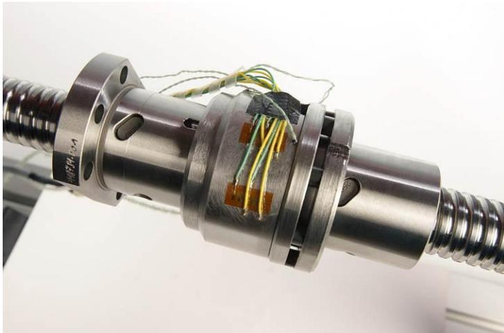
**Bild:** In Kugelgewindemuttern integrierte Formgedächtnisaktoren gewährleisten die Prozessstabilität von Werkzeugmaschinen. Quelle: © Fraunhofer IWU | Bildquelle in Farbe und Druckqualität: [www.iwu.fraunhofer.de/de/presse\\_und\\_medien.html](http://www.iwu.fraunhofer.de/de/presse_und_medien.html)
