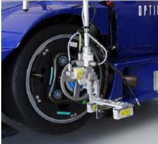
**Messsystem bestehend aus 6-Komponenten Messrad und optischem Geschwindigkeitssensor**
