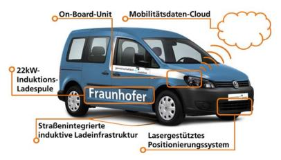
Überblick der Einzeltechnologien die im Projekt »Gemeinschaftlich-e Mobilität: Fahrzeuge, Daten und Infrastruktur (GeMO)« gemeinsam von sechs Fraunhofer-Instituten entwickelt und im Prototyp eines Fahrzeugs verbaut werden. ©Fraunhofer IAO 2013
