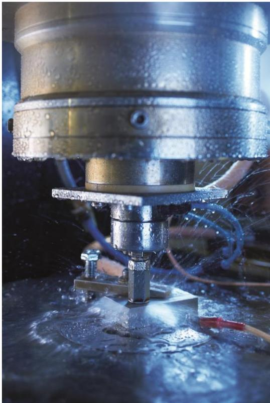
**Bild:** Das elektrochemische Abtragen ist insbesondere für schwer bearbeitbare Werkstoffe eine kosten- und ressourceneffiziente Alternative zur Zerspanung. Quelle: © Fraunhofer IWU |
