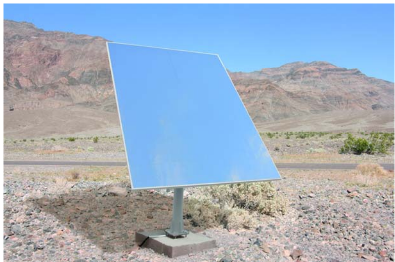
Prototyp eines Heliostaten der Firma Solar Tower Technologies AG, der durch seine proprietäre Nachführung die Errichtung sehr kompakter Heliostatenfelder ermöglicht. ©Solar Tower Technologies AG
