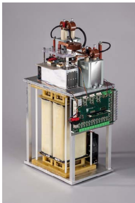
Am Fraunhofer ISE entwickelter 30 kW Mittelspannungs-DC/DC-Wandler mit 10 kV Bauelementen aus Siliziumkarbid. ©Fraunhofer ISE
