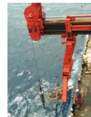
Entnahme eines Sedimentbohrkerns.
