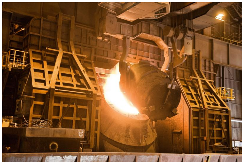
Bild 1: Roheisenchargierung am 190 t BOF-Konverter der Dillinger Hütte
