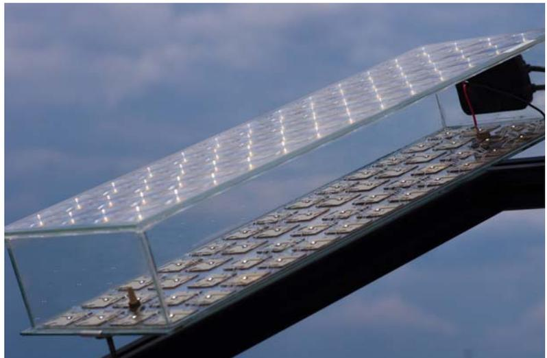
FLATCON<sup>®</sup>-Konzentratormodul mit einem Wirkungsgrad von 36,7 %.
