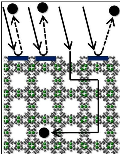
Die Beladung hochporöser metall-organischer Gerüste (MOFs) aus metallischen Knoten (grün) und organischen Verbindungselementen (grau) mit Gastmolekülen wird oft durch Barrieren an der Oberfläche behindert. (Abbildung: IFG/KIT)
