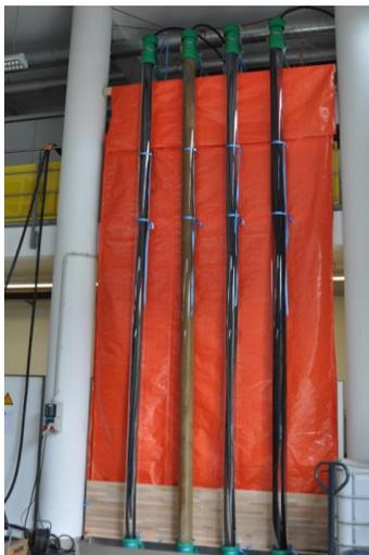
In sechs Meter hohen Versuchsaufbauten analysieren Forscher die Verfüllqualität von Erdwärmesonden. (Foto: Julian Rolker/Solites)
