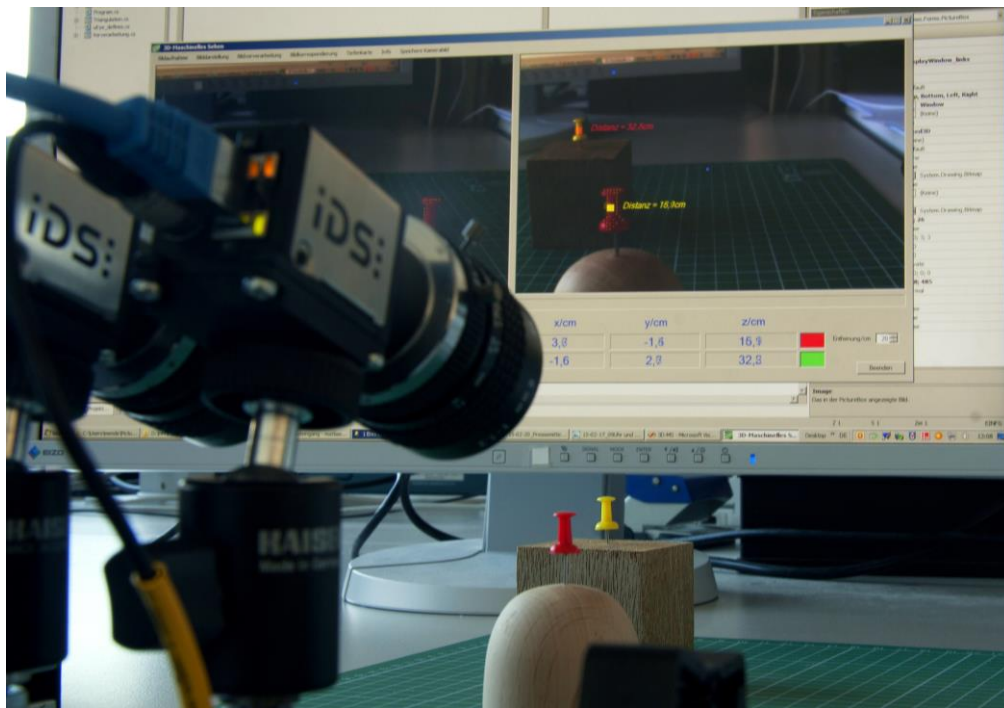
Bild: Das System zum 3D-maschinellen Sehen ahmt die Funktionsweise des Auges nach und liefert exakte Informationen über den Standort und die Identifikation eines Objekts im Raum, Quelle: © Fraunhofer IWU | Bildquelle in Farbe und Druckqualität: www.iwu.fraunhofer.de .
