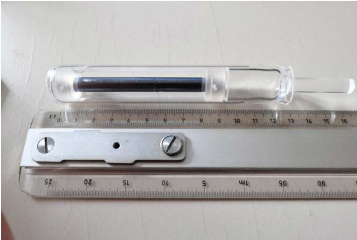
Terrestrische Vergleichsprobe des ParSiWal-Experimentes: Siliziumstab mit Partikeldepot, der in einer Quarzglasampulle gehalten ist. Die Ampulle wird in die Spiegelofenanlage ELLI eingebaut. Bild: Albert-Ludwigs-Universität Freiburg
