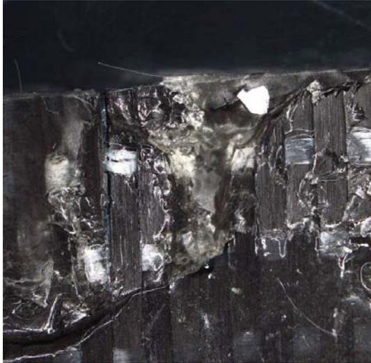
CFK in Epoxidmatrix nach einer Behandlung mit einem Mix von Mikroorganismen. Ein deutlicher Abbau der Matrix ist sichtbar. ©Hohenstein Institute
