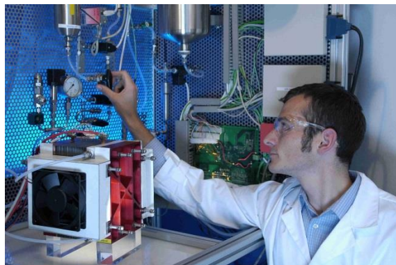
Teststand für Wasserelektrolyseure. ©Fraunhofer ISE
