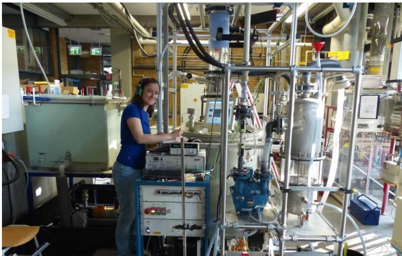
Anlage zur Untersuchung der Verdampfung in solarbetriebenen Entsalzungsanlagen
