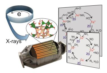
Mithilfe von Röntgenstrahlung lassen sich Reaktionen in Katalysatoren unter realitätsnahen Bedingungen beobachten. (Abbildung: KIT-ITCP)
