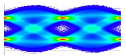
Mit sogenannten Eye-Diagrammen wird die Qualität der elektro-optischen Modulatoren geprüft. Bild: (C. Haffner/ETH)
