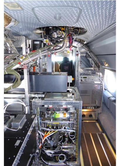
An Bord von HALO: Im Hintergrund rechts das Rack mit den Messgeräten des KIT, oben das Ozongerät, darunter das Massenspektrometer. (Foto: Dr. Felix Geiger)
