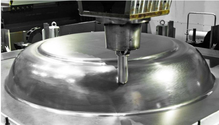
**Bild:** Im weltweit einzigartigen Bearbeitungszentrum am Fraunhofer IWU können besonders großformatige Bauteile inkrementell umgeformt werden. Im Bild: Gehäusebauteil für Windkraftanlagen. Quelle: © Fraunhofer IWU | Bildquelle in Farbe und Druckqualität: [www.iwu.fraunhofer.de/de/presse\\_und\\_medien.html](http://www.iwu.fraunhofer.de/de/presse_und_medien.html)
