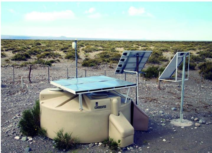
*Ein Prototyp von AugerPrime: Jeder existierende Wasser-Cherenkov-Detektor mit 12 000 Litern Wasser wird um einen vier Quadratmeter großen Szintillator erweitert. (Foto: Pierre Auger Collaboration)*
