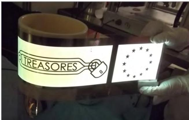
Eine flexible Lichtquelle aus organischen LED (OLED), die im Rahmen des TREASORES-Projekts entwickelt wurde. Ein Schlüsselbereich dieser Technik sind flexible Elektroden und luftundurchlässige Barrierschichten. Diese leuchtende Folie wurde am Fraunhofer FEP in Dresden in einem kostengünstigen Rolle-zu-Rolle-Prozess hergestellt.
