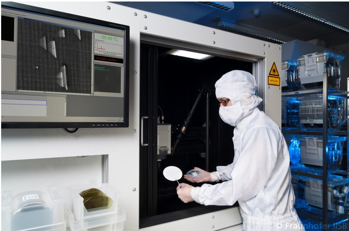
*Mit dem neu entwickelten Photolumineszenz-Messsystem lassen sich bereits während der Produktion kleinste Materialfehler in Siliziumkarbid-Wafern nachweisen. Bild: Fraunhofer IISB*
