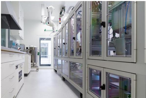
**In der Druckwechseltechnologie-Forschungsanlage am Fraunhofer IGB kann die Haltbarmachung von Getränken und flüssigen Lebensmitteln, aber auch der Aufschluss von Zellen, unter GMP-Bedingungen untersucht werden.**
