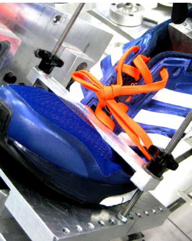
Abbildung 2: Testapparatur zur Bestimmung der Biegesteifigkeit von Schuhen. Das Gerät ist ein spezieller Eigenbau des PFI. (Bildquelle PFI)
