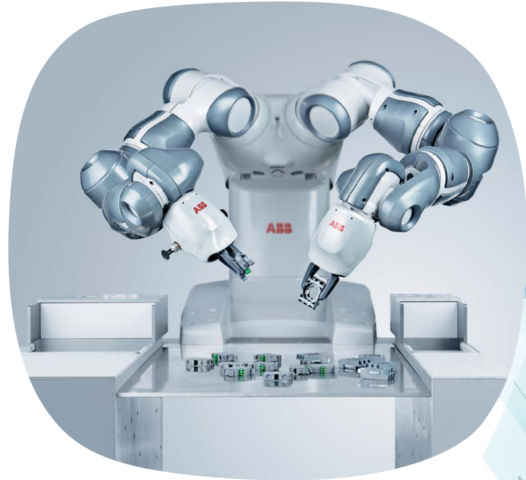
ABBILDUNG 3: Zweiarmiger Greifarm- roboter YuMi von ABB (Quelle: ABB).
