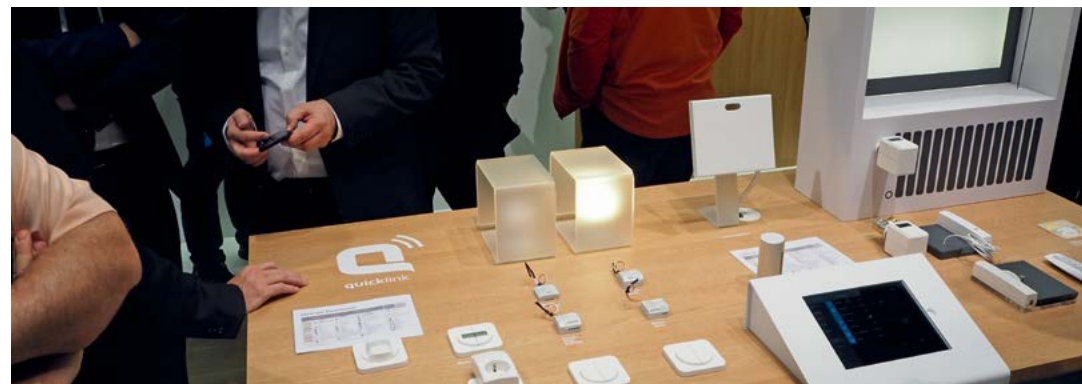
ABBILDUNG 7: Plug-and-Play-Funksystem „Quick Link“, das im Nachrüstmarkt neue funkbasierte und leicht nachrüstbare modernste Sensorik und Aktuatorik ermöglicht (Quelle: Hager Group).
