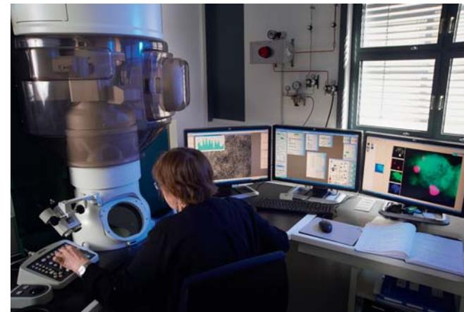
Abb. 2: Atomar aufgelöste Mikroskopie - JEOL ARM 200F (Foto: LIKAT)
