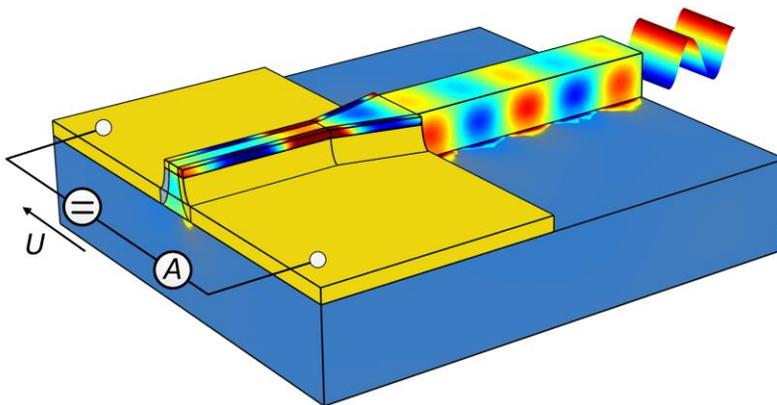
Ein plasmonischer Detektor, der direkt an einen Silizium-Lichtwellenleiter angekoppelt ist und weniger als ein Mikrometer groß ist, wurde am KIT entwickelt. (Grafik: KIT)
