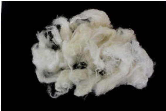
Abb. 1: Alginate-Viskose-Fasern, hergestellt mit bakteriellem Alginat.
