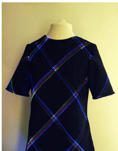
Leuchtende Fasern erzeugen wechselnde Tartan-Webmuster auf dem Kleidungsstück (Bild: L. Fraguada/E. Bigger)
