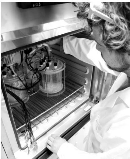
Der Biologe Johannes Eberhard Reiner vom KIT mit den Reaktoren zur mikrobiellen Elektrosynthese. (Foto: Constanze Zacharias)
