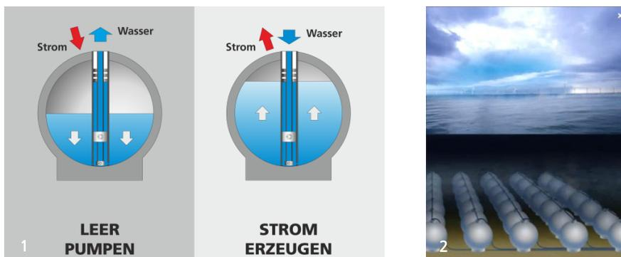
1. Funktionsprinzip | 2. Konzept für ein Meeres-Pumpspeicherkraftwerk mit vielen Kugelspeichern (ca. 30 m Durchmesser) in 600 - 800 Metern Wassertiefe zur Zwischenspeicherung von Offshore-Strom
