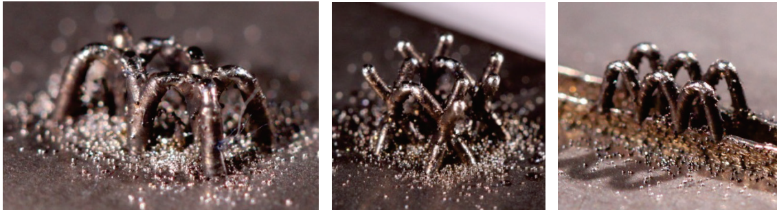
Abbildung 1: Generierte 3D-Strukturen in periodischer Anordnung, Höhe 1,8 bis 2,8 mm © Fraunhofer IWS Dresden
