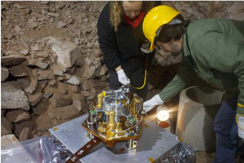
Das SEIS-Instrumentenpaket während der Installation im Teststollen des BFO, 110 Meter unter der Erdoberfläche. (Foto: Björn Oldsen)
