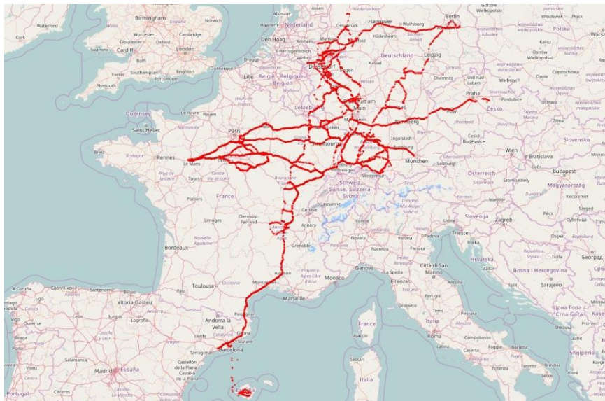
Im Rahmen einer Wirtschaftlichkeitsstudie hat das Fraunhofer ISE 40t Kühllaufleger mit Einstrahlungssensoren versehen. Auf deren handelsüblichen Routen in den USA und Europa – von Prag nach Mallorca, von Paris nach München – wurden dafür ein halbes Jahr lang reale Einstrahlungsdaten gemessen und ausgewertet. ©Fraunhofer ISE (Kartendaten OpenStreetMap , Karte GPS Visualizer )
