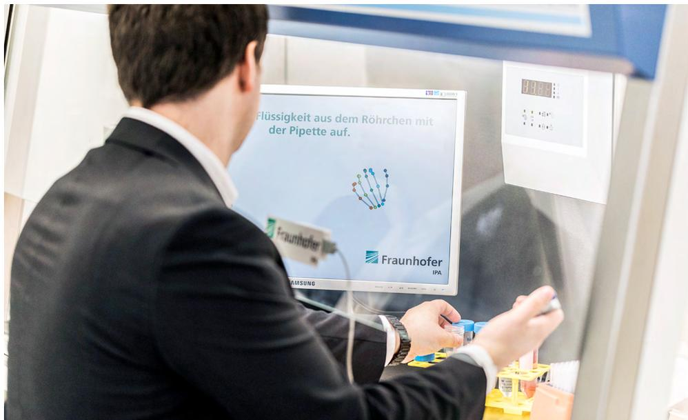
Das Trackingsystem des Fraunhofer IPA dokumentiert Handbewegungen mit 3D-Bildverarbeitung automatisch und wertet sie intelligent auf. Das erspart die manuelle Dokumentation bei Versuchen. (Quelle: Fraunhofer IPA, Foto: Heike Quosdorf)
