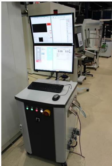
Abb. 3: remoweld®MES-Steuer- und -Regel-Tower
